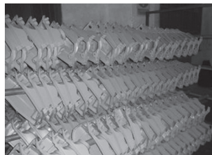
图4 Y1W灯体挂架冷却示意图
